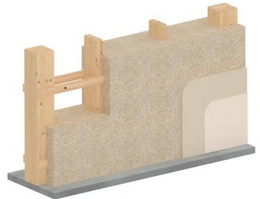
2. Verkleidung auf neuer Holzkonstruktion
