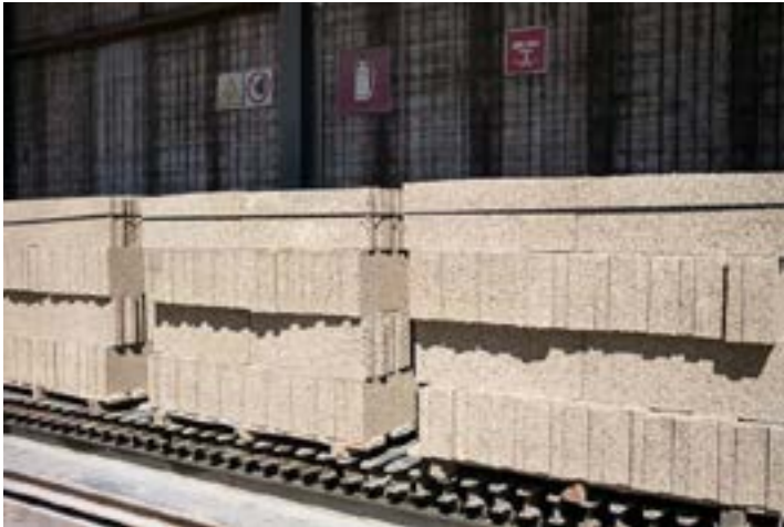
Der neue Trockenbauproduktstoff: Hanfziegel aus der ersten marktreifen Produktion.
